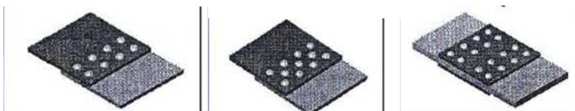
Figura 1. Tipuri de îmbinări nituite
